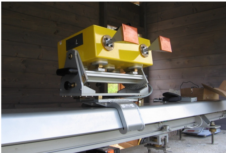
Sistema radar a terra (IBIS-L)
