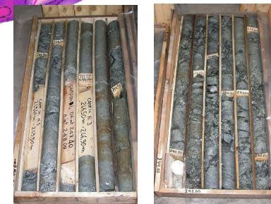
Cassette con campioni alla profondità della fascia di scivolamento
