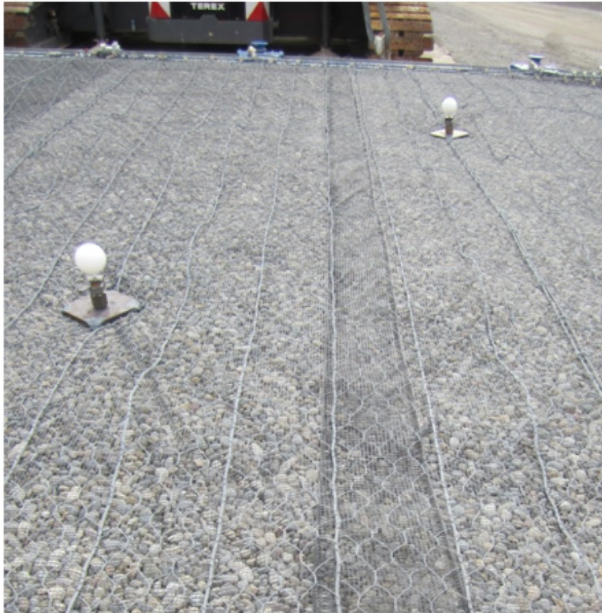
Test # 7, 20.03.2013, rete ibrida, a = b = 3.5 m Ghiaia di fiume, fuso 16...32 mm
